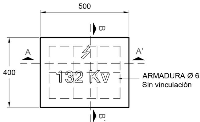
CORTE A-A' - LOSA CUBRECABLES 132 KV - Con armadura
