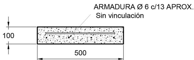
CORTE A-A' - LOSA CUBRECABLES 132 KV - Sin armadura
